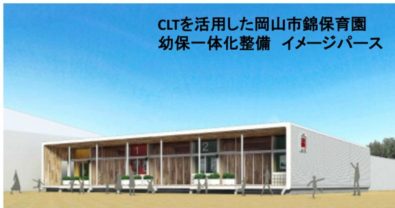
CLT(Cross Laminated Timber)とは丸太から切り出した挽き板を水平・垂直方向に交互に3層以上積層接着させることにより、設計上必要な寸法と強度を確保する工場生産の木質建材。国内の森林資源の有効活用による環境負荷の低減が期待される。
